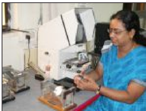
चित्र 2 : एच.वी.आई. यंत्र व कम्प्यूटर द्वारा परीक्षण
