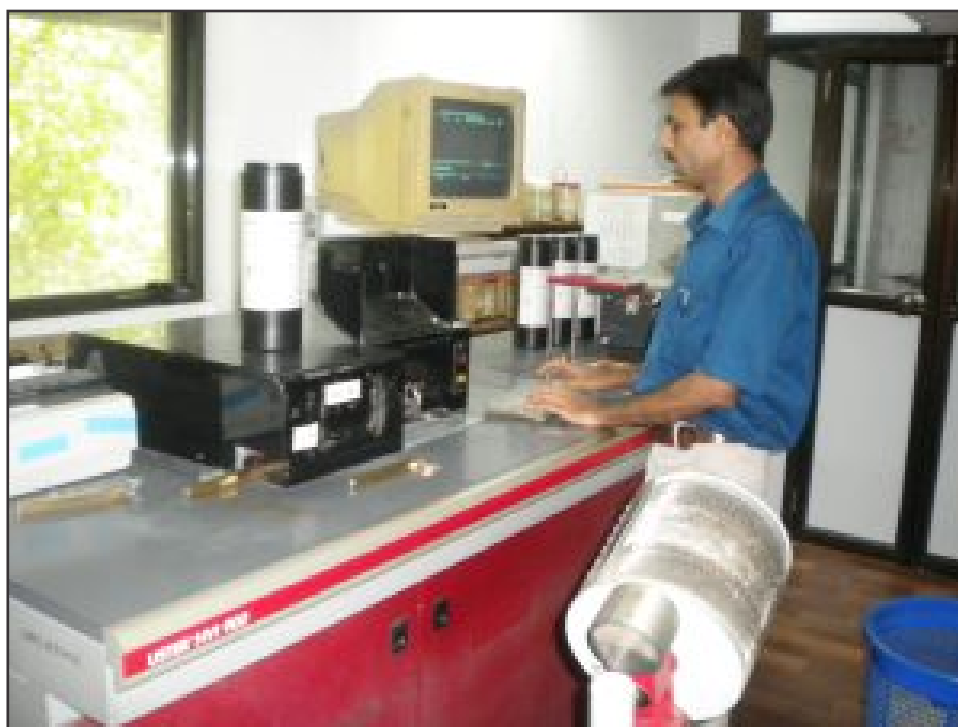
चित्र 1 : एच.वी.आई. यंत्र व कम्प्यूटर द्वारा परीक्षण
